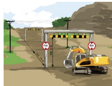
Rys. 4. Prace w bezpośrednim sąsiedztwie napowietrznych linii energetycznych
