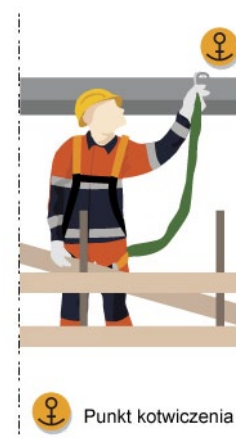
Rys. 2. Ochrona indywidualna przed upadkiem z wysokości
